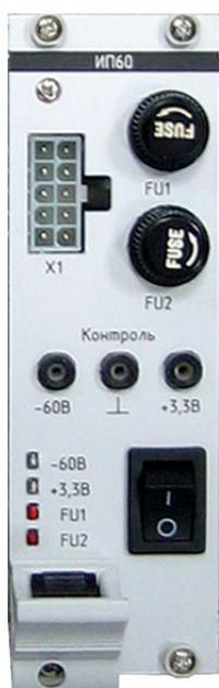
Перечисление органов управления и индикации сверху вниз. Разъем X1 служит для ввода в изделие батарейного напряжения. Контрольные терминалы предназначены для удобства проведения регламентных работ. Светодиодные индикаторы «-60В» и «+3,3В» отображают наличие питающих напряжений, а «FU1» и «FU2» исправность предохранителей FU1 и FU2. Тумблер служит для включения и выключения питания изделия.
